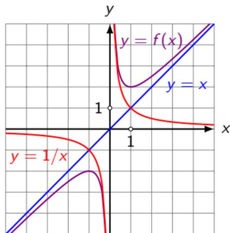
Graphen der beiden Teilfunktionen  $y = x$  und  $y = 1/x$  können durch Ordinatenaddition zur Summenfunktion  $y = x + 1/x$  superponiert werden.
