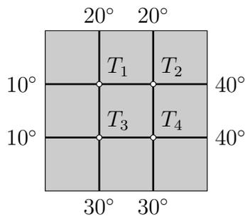
$T_1, T_2, T_3$  und  $T_4$  bezeichnet die Temperatur an den vier inneren Punkten der Platte. Die Temperatur dort entspricht näherungsweise dem Mittelwert der vier unmittelbar benachbarten Punkten.
