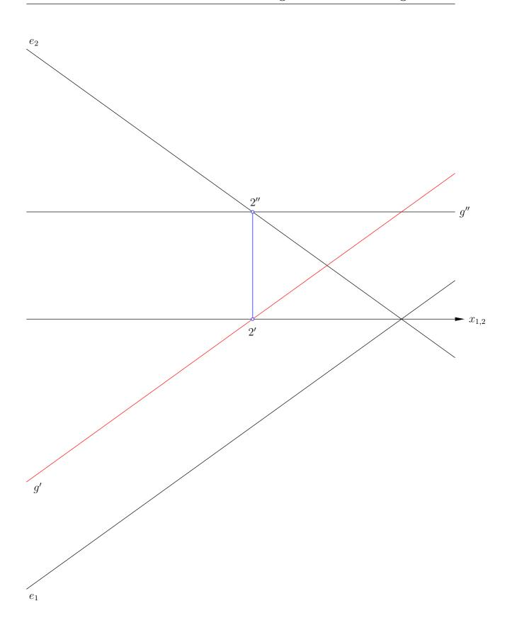
Da g'' parallel zur Rissachse ist, handelt es sich bei g um eine erste Hauptgerade. Daher muss der Grundriss parallel zur ersten Spur  $e_1$  von  $\varepsilon$  liegen.
