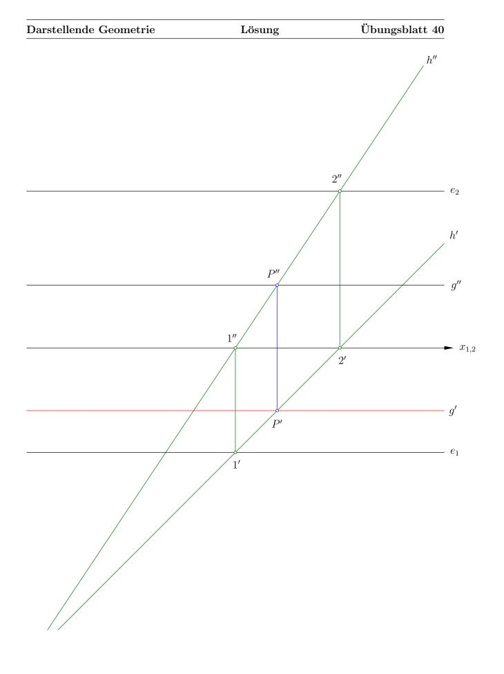
Mit einer Hilfsgerade h'' (zu der natürlich noch der Grundrss h' konstruiert werden muss) "binden" wir g an die Ebene  $\varepsilon$  an. Der Rest ist wieder Standardkonstruktion.
