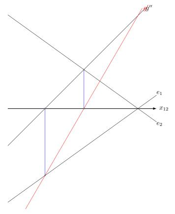
Der Schnittpunkt von g'' und  $e_2$  ist der Aufriss des zweiten Spurpunktes von g. Der Schnittpunkt von g'' und  $x_{12}=e_2'$  ist der Aufriss des ersten Spurpunktes von g.
