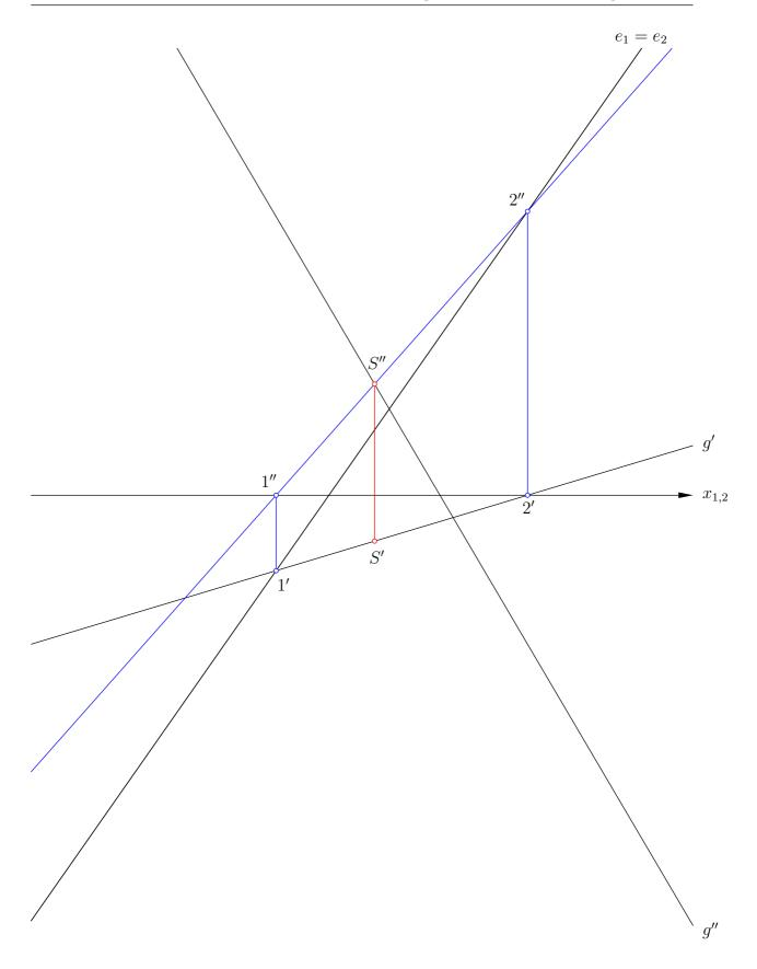
Zur Erinnerung: Bei den Spuren einer Ebene  $\varepsilon$  werden nur der Grundriss der ersten Spur  $e_1' = e_1$  und der Aufriss der zweiten Spur  $e_2'' = e_2$  gezeichnet, da  $e_2'$  und  $e_1''$  immer mit der Rissachse  $x_{1,2}$  zusammenfallen.
