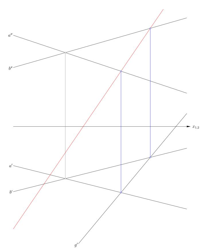
Aus den Schnittpunkten von g' mit den Grundrissen a' und b' lassen sich sofort die Aufrisse und damit auch g'' konstruieren.
