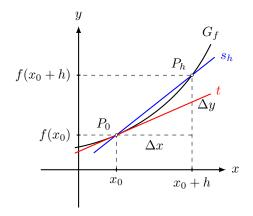
$\frac{\Delta y}{\Delta x}$ : Steigung der Sekante  $s_h$  durch  $P_0$  und  $P_h$
