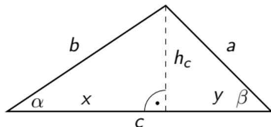
$$\frac{x}{b} = \cos \alpha \quad \Rightarrow \quad x = b \cdot \cos \alpha \quad (x \text{ ist Projektion von } b \text{ auf } c)$$
