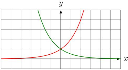
Spiegeln des Graphen an der  $y$ -Achse:
